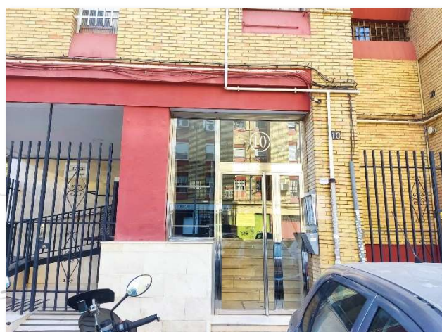
Portal inox con dos hojas con apertura automática y vinilo
